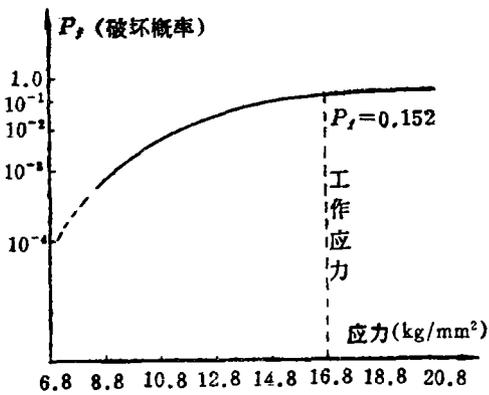
图 4 破坏概率随应力的变化
