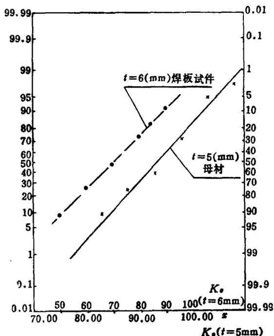
图2 在正态概率坐标纸上的 $K_c$ 分布点
