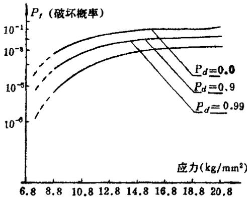
图 5 破坏概率随应力，可检概率的变化
