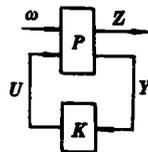
图 2 动态反馈控制器设计
