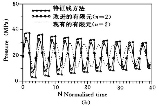
图4 阀门按指数曲线关断后阀门前的压力曲线 ( $L = 24\text{m}$ )
