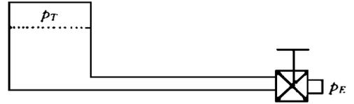
图 2 连接贮箱和阀门的单支管道
