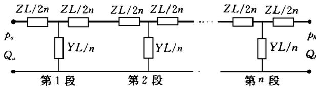
图1 流体传输管道的电气模拟
