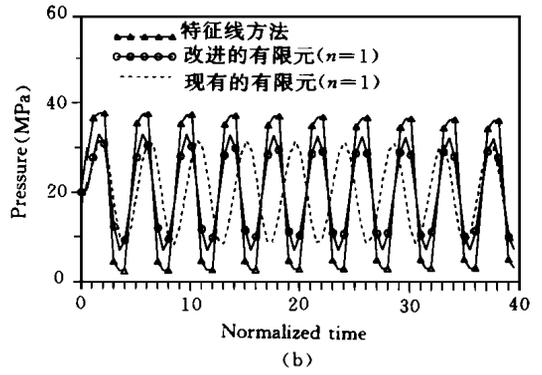
图3 阀门按指数曲线关断后阀门前的压力曲线 ( $L = 2.4\text{m}$ )
