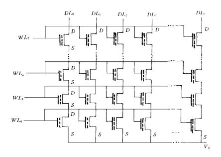
图 3 Flash 存储器 NAND 存储结构示意
