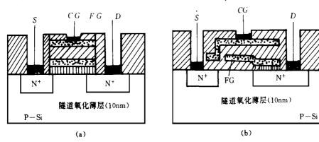
图 1 Flash 存储器单管叠栅位元结构
