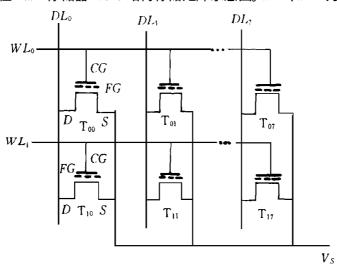
图 2 Flash 存储器 NOR 存储结构示意
