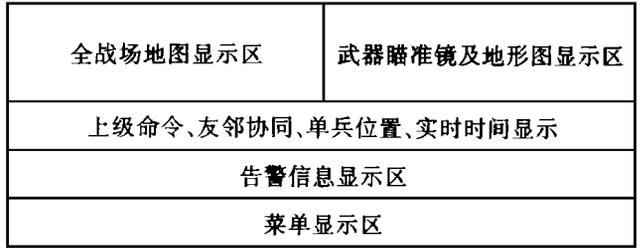
图2 人机接口界面屏幕划分示意图
