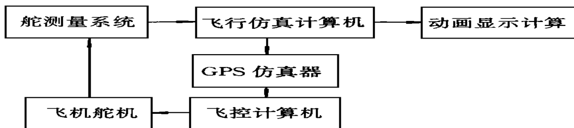
图2 GPS导航的半实物仿真系统框图
