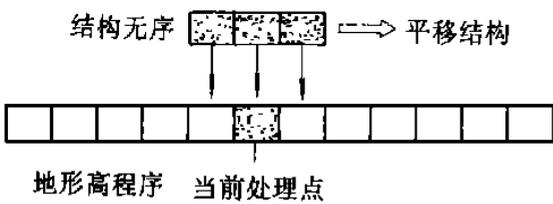
图3 数字空间中形态腐蚀、膨胀处理示意图
