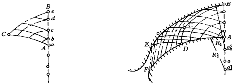
图3 喷管设计过程
