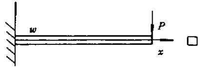
图 1 带随机材料参数的静悬臂梁
