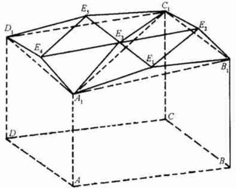
图1 中点位移三角网格法
