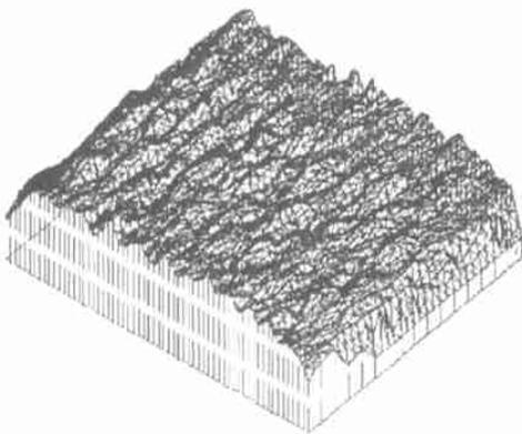
图3 具有方向性分形特征的中点随机位移三角网格法
