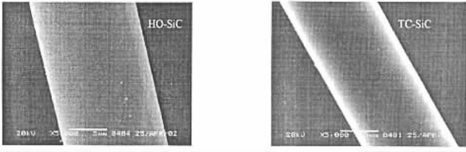
图 10 连续 SiC 纤维的 SEM 图
