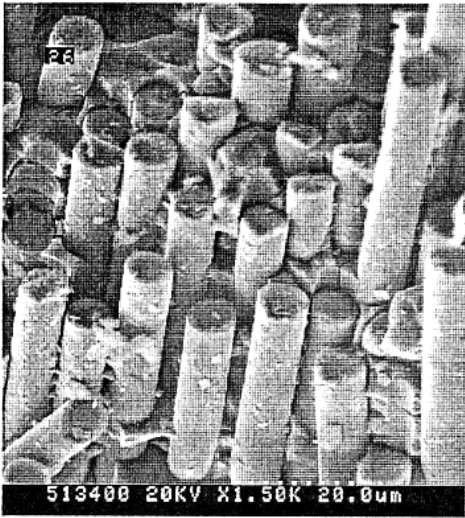
图3 加入 \text{SiO}_2 空心微珠(1250目)的材料断口扫描电镜照片
