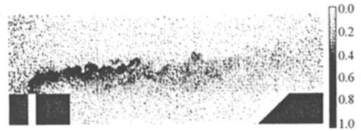
图 4 实验横向射流组分数云图 Fig. 4 Experimental contour of transverse jet
