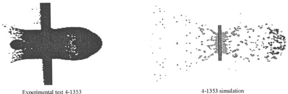
图 3 超高速碰撞形成的碎片云 X 光照片与数值模拟结果的比较 Fig. 3 Debris clouds from X photograph and simulation
