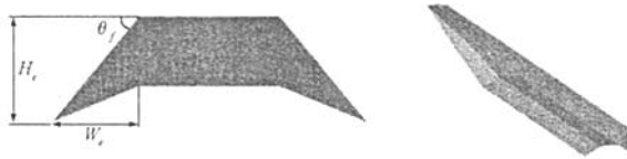
图 4 基于“Δ”形乘波构型侧缘的前体外形及其参数定义
