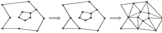
图1 耳尖移除法生成初始网格
