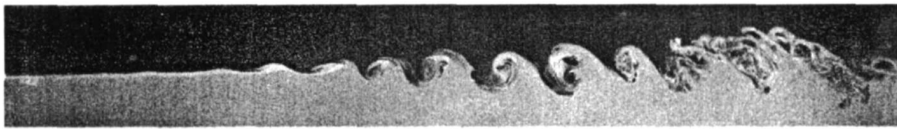
图 8 M_c = 0.2 超声速混合层 NPLS 图像
