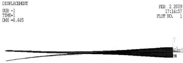
图 6 叶片模型极限挥舞变形图
