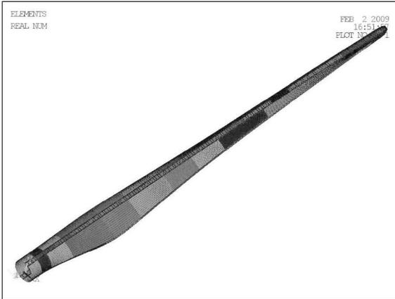
图2 风力机叶片有限元模型
