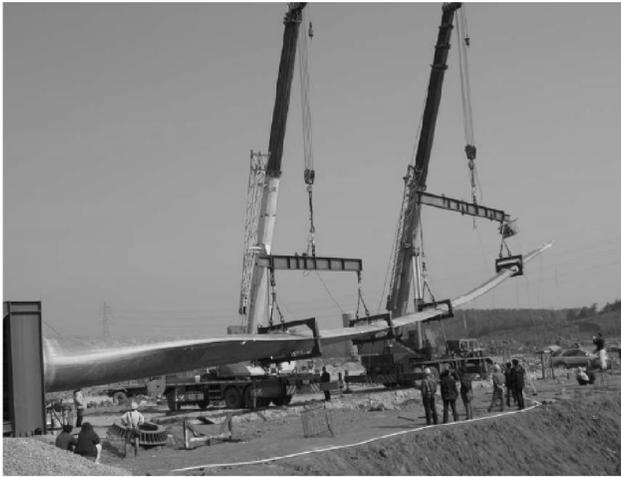
图8 叶片全尺寸静力试验图
