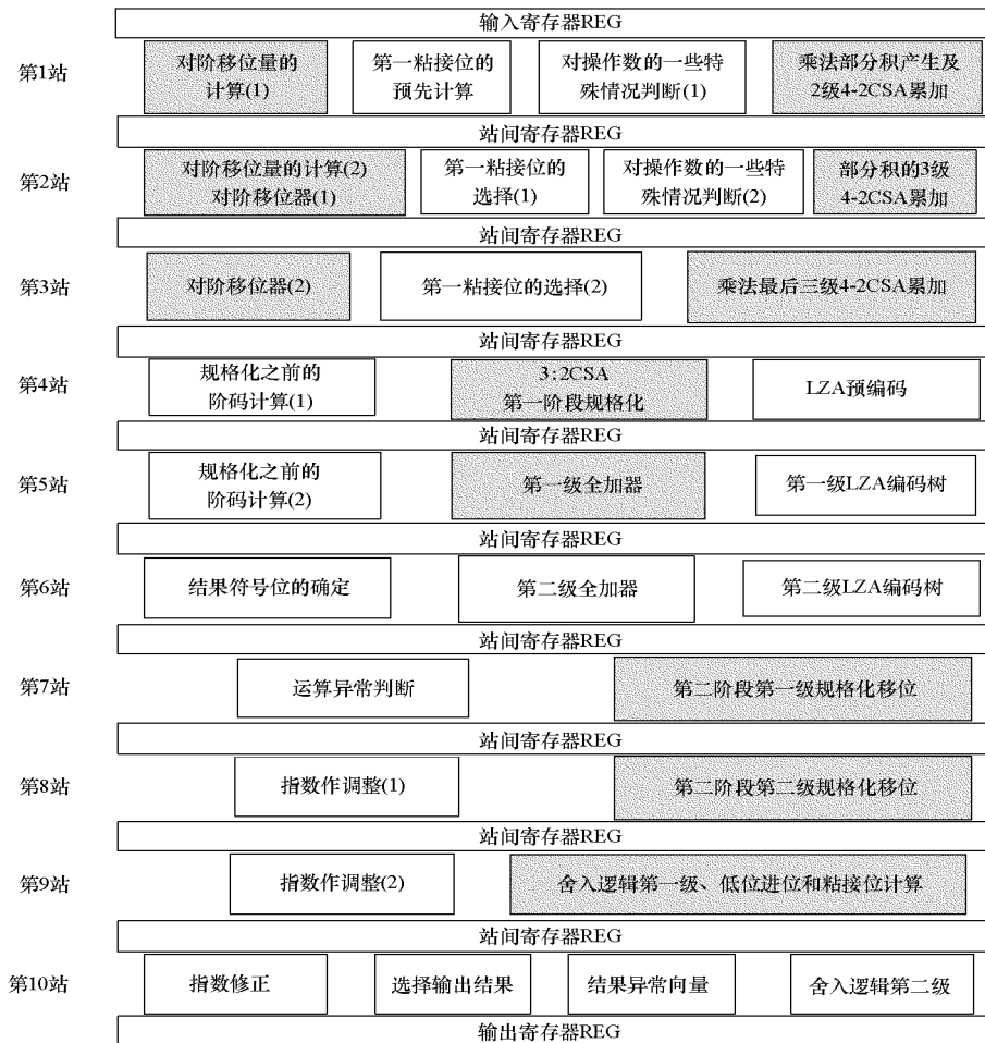
图3 128位浮点乘加部件全流水实现
