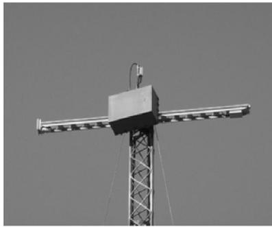
图8(b) 模拟器射频前端
