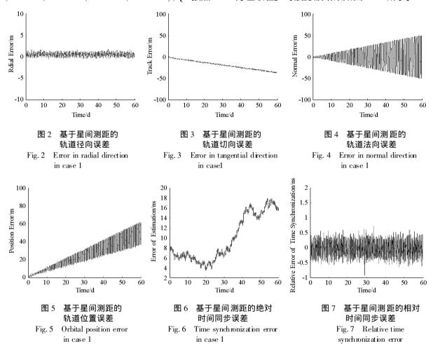
从图 2~ 7 可以看出, 在轨道初始误差较小的情况下, 仅利用星间测距进行 60day 自主导航, 轨道切向和法向方向误差逐渐累积至 50m, 这是由于仅星间测距时星座整体旋转不可测, 存在整体旋转误差; 卫星钟差估计误差累积至 20ns, 存在整体漂移, 但星间相对时间同步误差仅为 0. 5ns, 精度较高。
