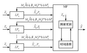
图 1 组合滤波器结构图
