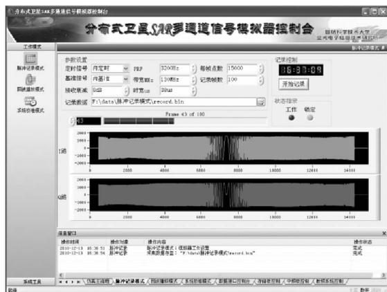
图 7 脉冲记录模式测试结果
