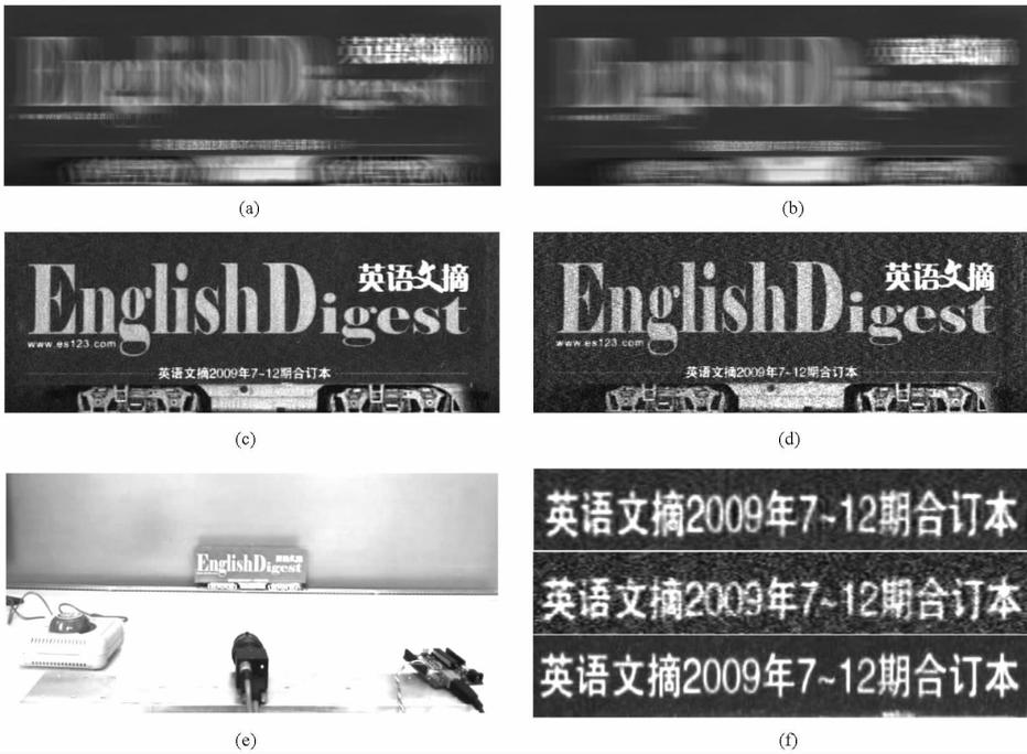
图 6 真实编码曝光图像复原实验及实验环境
