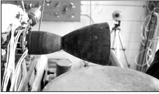
图 5 C/SiC 复合材料整体燃烧室热试车后照片
