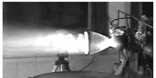
图4 C/SiC 复合材料整体燃烧室热试车过程照片
