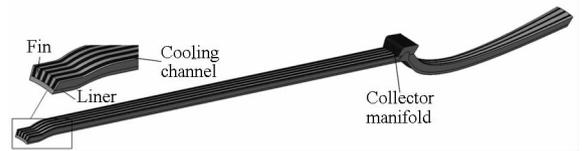
图 2 加热器传热计算简化模型
