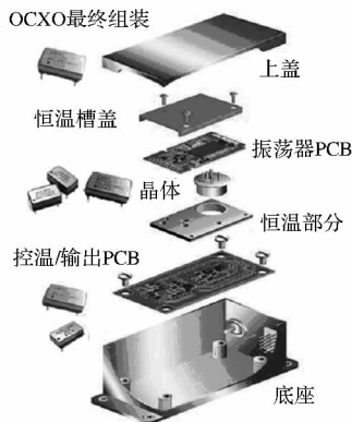
图 3 恒温型石英晶体振荡器电路结构 Fig.3 Structure of OCXO
