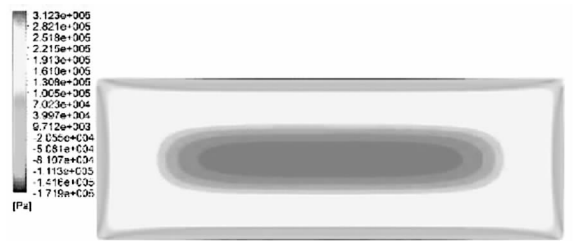
图 7 多孔质气体静压轴承表面压力分布图
