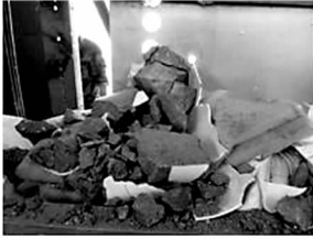
(a) PVC 管外径 160mm, 847.1m/s
