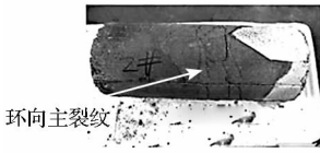
(b) 核心混凝土侧面 (b) Side face of core concrete
