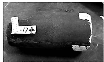
(b) 核心混凝土侧面 (b) Side face of core concrete
