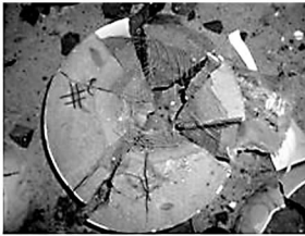
(b) PVC 管外径 315mm, 839.9m/s
