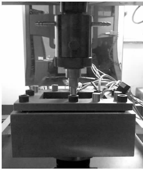
(a) 准静态压痕实验装置
