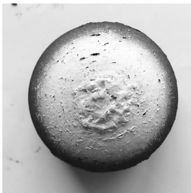
图 10 改性 C/C 模型高频等离子体风洞考核后照片
