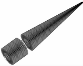
图 2 盘缝带伞初始折叠有限元模型
