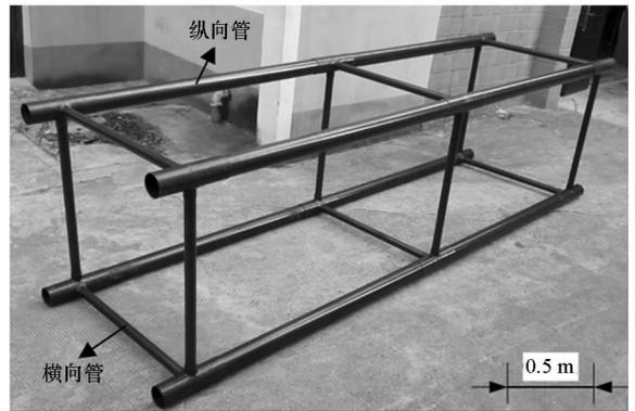
图 1 振动实验测试用桁架结构段
