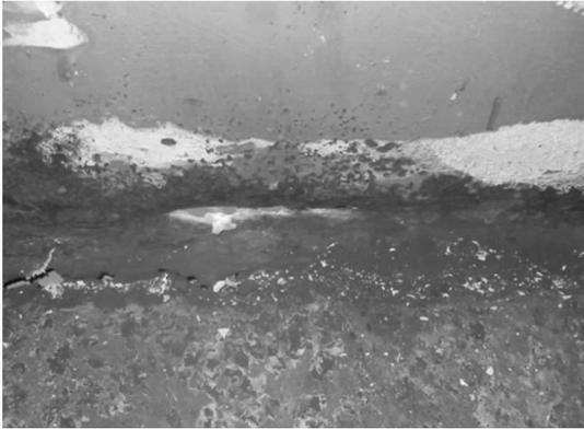
图 2 平台板的点蚀损伤
