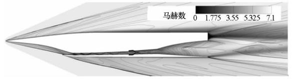
图 8  $t = T$  时刻对称面马赫数云图及压力等值线
