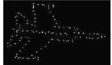
图2 米格-25 散射点模型 Fig. 2 Scattering model of MIG-25
