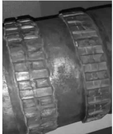
图 11 实际弹带变形图
