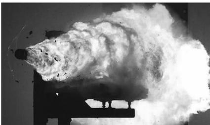
图10 电磁发射装置炮口拉弧
