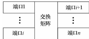
图6 SpW路由器的典型结构
