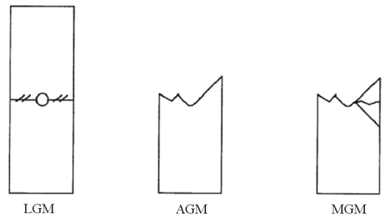
图2 可接受的开孔拉-压破坏模式
