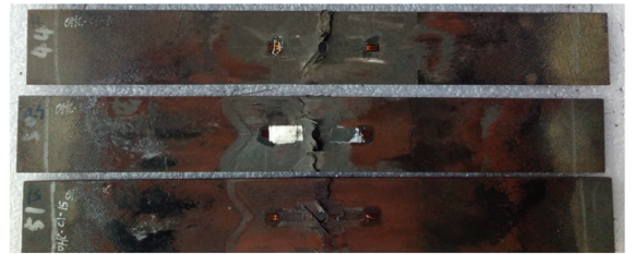
图 6 C1 铺层试验件疲劳试验典型破坏模式 ( R = -1 )
