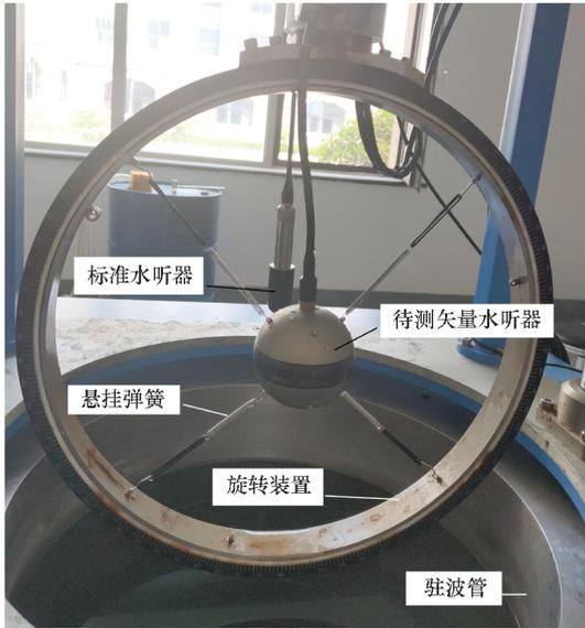
图9 矢量水听器驻波管测试现场
