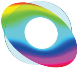
图 4 悬臂圆柱管受均布载荷作用时, x=0 横截面无量纲正应力 \sigma_{xx} I / qL^3 分布
