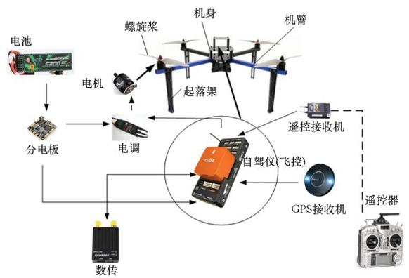
图10 四旋翼无人机框架结构
