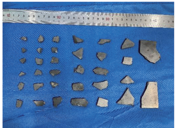
图4 试验后收集到的部分陶瓷碎片
