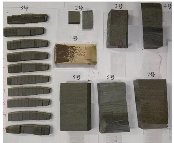
图 1 发动机药柱取样试样
