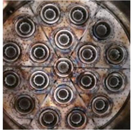
图 18 喷注面板烧蚀照片
