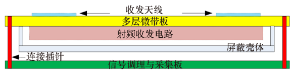
图5 一体化雷达射频前端叠层方案
