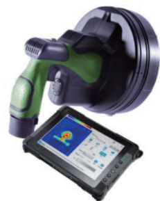
图 8 穿透成像雷达系统实物图
