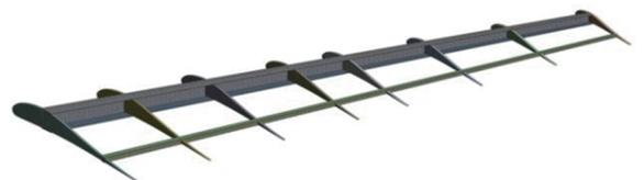
(b) 机翼结构内部网格
