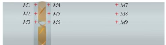
图 13 压力脉动监测点示意图
