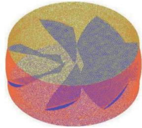
图2 HPT叶轮模型水体网格
