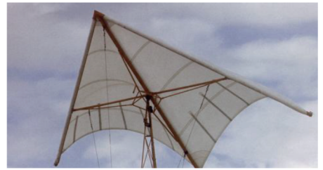
(b) 龙骨式翼伞 (b) Keel parafoil
