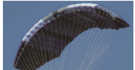
(d) 梯形翼伞 (d) Trapezoidal parafoil
