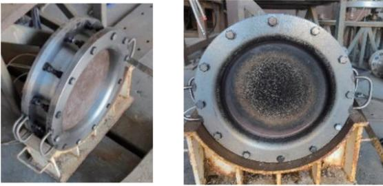
(a) 烧蚀前状态 (b) 烧蚀后状态
